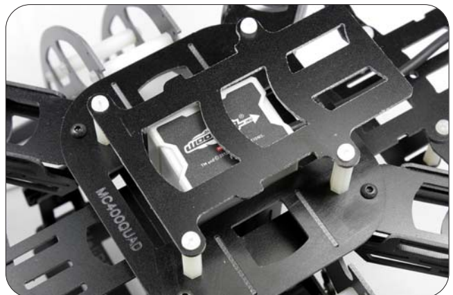
例子 2: 安裝 DJI WK-M IMU 模塊 Example 2: Install the DJI WK-M IMU Module
